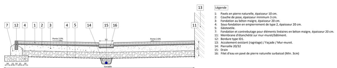
**Profils en travers type 3: Raclage/Pose-Trottoir pavés béton : 1/25**
